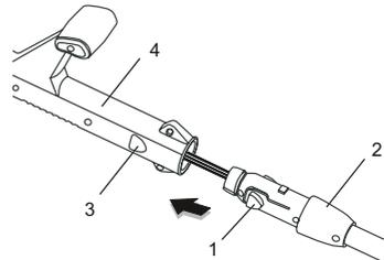
2. Alinee los cierres (1) con los orificios de posicionamiento (3) y deslice los dos ejes.
