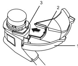
3. Alinee el orificio de tornillo (2) de la protección con el orificio de tornillo (3) del cabezal de corte.
