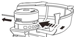
3. Después de extender el nuevo hilo de corte, devuelva siempre la máquina a su posición normal antes de volver a ponerla en marcha.
