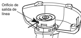
7. Presione las pestañas e instale la cubierta del carrete en la carcasa del carrete.
