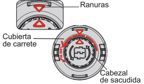
3. Introduzca el hilo de corte por el orificio. Introduzca el hilo de corte hasta que salga por el orificio contrario.
