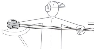
5. Gire la tapa del carrete en sentido antihorario para enrollar el hilo de corte en el cabezal de corte. Mantenga aproximadamente 5 pulgadas (12,5 cm) de hilo de corte en cada lado del cabezal de corte.
