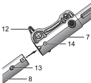
4. Gire el eje inferior hasta que el botón se bloquee en el orificio de posicionamiento.
